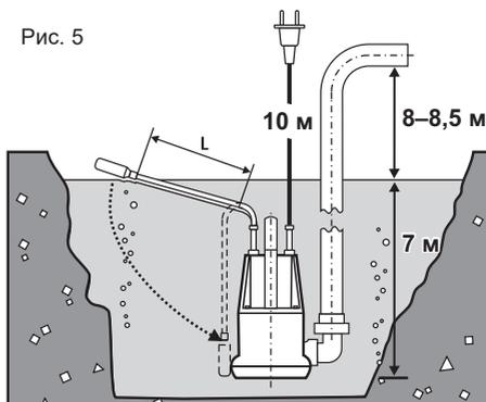
**Примечание!** Уровни включения и выключения насоса регулируются **ОДНОВРЕМЕННО**. При установке определенного верхнего уровня (включения насоса) убедитесь, что в нижнем положении выключатель обеспечивает своевременное (до оголения водозаборных отверстий в нижней части) выключение насоса. При уменьшении длины **L** уменьшается разность уровней включения и выключения.
