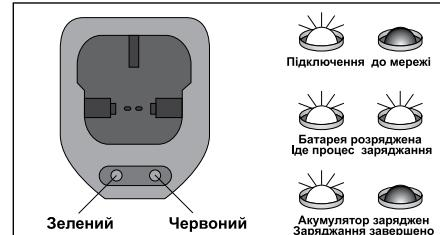
Для зарядки акумулятора підключіть зарядний пристрій до робочої станції і вклічіть в розетку. Натисненням бічних фіксаторів 7 звільніть батарею 6 з кріпління, зніміть її з виробу і установіть в зарядний пристрій.
