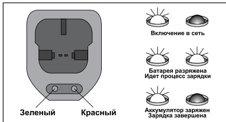
Для зарядки аккумулятора подключите зарядное устройство к рабочей станции и включите в розетку. Нажатием боковых фиксаторов **7** освободите батарею **6** из крепления, снимите ее с изделия и установите в зарядное устройство.
