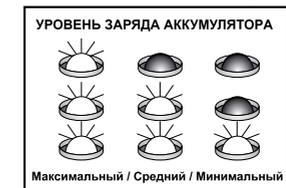
На Вашем изделии установлены индикаторы, которые позволяют контролировать степень заряда аккумуляторной батареи. Для проверки нажмите кнопку 10. Индикаторы 6 покажут состояние батареи.
