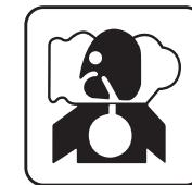
Выхлопные пары двигателя токсичны и могут привести к отравлению. Не запускайте двигатель и не оставляйте его работающим в помещениях и в положении, когда выхлопные пары могут попасть в органы дыхания людей и животных
