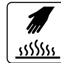
В процессе работы абразивный инструмент сильно нагревается. При необходимости замены дождитесь его остывания или используйте защитные перчатки
