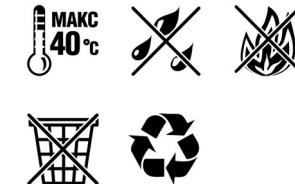
Li-Ion батарея требует особых условий эксплуатации и хранения:
