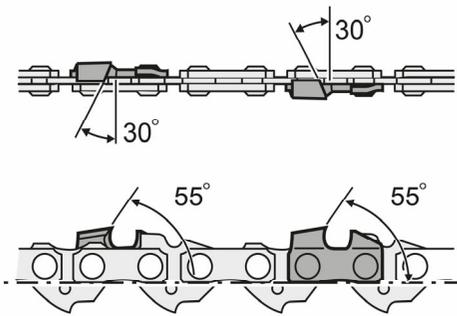
Угол заточки в  $30^\circ$  должен быть одинаковым на всех зубьях. Разница в углах заточки может привести к резкому и неравномерному движению цепи, ускоренному износу и к разрыву цепи.
