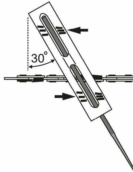
При стачивании режущего элемента, периодически требуется правка высоты глубиномера. Для этого сточите глубиномер плоским напильником (в комплект поставки не входит).
