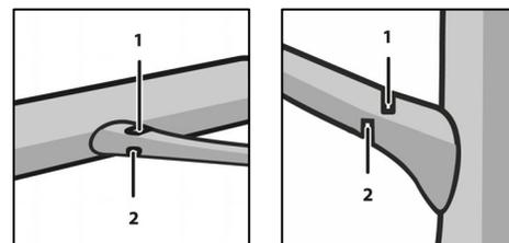
При опиливании веток, не находящихся под натяжением, сначала следует надпиливать со стороны, в которую будет отпадать ветка, затем отпиливать с противоположной стороны. При отпиливании тонкой ветки пазы могут совпадать, при отпиливании толстой – обязательно должны иметь смещение.
