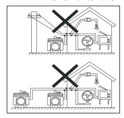
Подключение необходимо выполнять **ТОЛЬКО** через коммутационное устройство (например, двухполюсный переключатель), исключающее одновременное подключение к нагрузке обоих источников.
