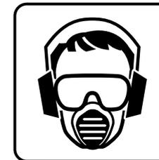
Изделие в процессе работы производит мелкодисперсную древесную пыль и создает повышенный шум. Используйте средства индивидуальной защиты.
