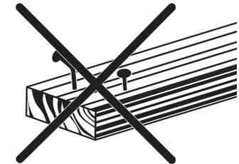
Перед началом работы убедитесь в отсутствии в заготовке металлических включений (гвозди, шурупы и т.д.)
