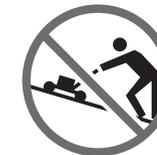
Не эксплуатируйте устройство на склонах с уклоном более 20°. Подстригайте траву в поперечном направлении к спуску склона, а не в направлении подъема и спуска.
