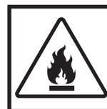
Не работайте вблизи открытого огня и искр при заправке топливного бака и при работе с топливом. Дайте двигателю остыть 2 мин перед заправкой
