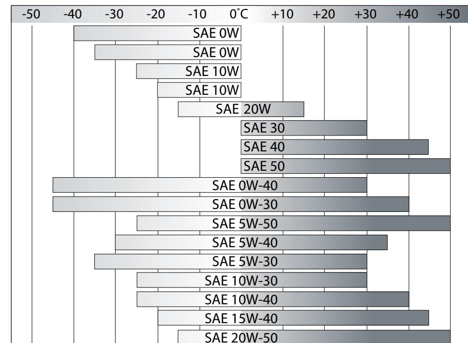
■ приготовьте масло, используя нижеследующие виды моторного масла, в зависимости от погодных условий (для четырехтактных моторов, класса не менее SH по классификации API). Рекомендуемый тип для работ в районах с умеренным климатом – SAE10W-30. Рекомендуем использовать масло ЗУБР 70610-1;
