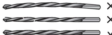
**Опасно!** Не прикасайтесь к работающему сменному инструменту! Не используйте поврежденный сменный инструмент (изогнутый, треснутый)!
