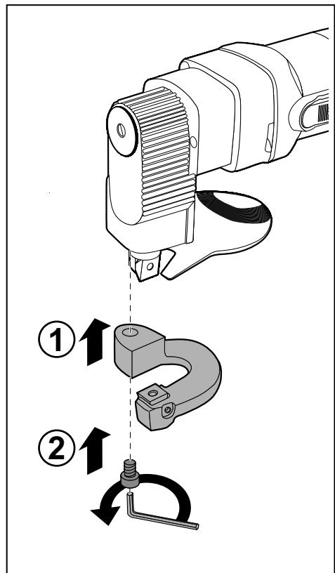
2. Регулировка рабочего зазора
