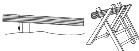
При пилении очень толстой или очень твердой заготовки делайте пропилы на глубину до 1/3 толщины и поворачивайте заготовку вокруг своей оси до полного распила.
