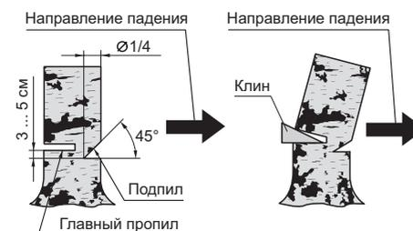
1) Выполните подпил на четверть диаметра ствола со стороны предполагаемого направления падения. Верхний пропил должен быть произведен под углом около 45°, нижний – горизонтально, таким образом, чтобы он пересекся с верхним и не был ниже него.
