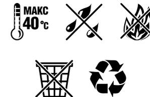
Li-Ion батарея требует особых условий хранения и эксплуатации:
