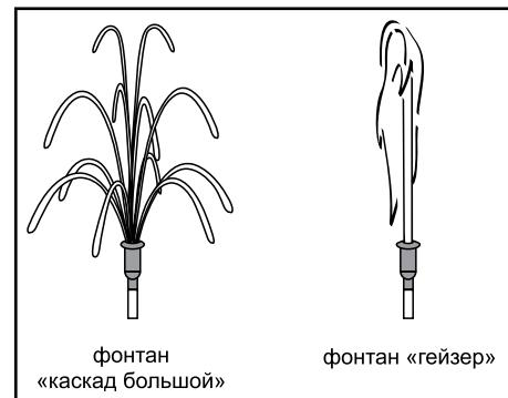
**Примечание!** Форма и высота показанных фонтанов являются примерными и могут отличаться в зависимости от мощности насоса, глубины погружения и высоты подачи воды, модели насадки и ее регулировки (для фонтана «колокольчик»).
