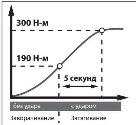
**ПРИМЕЧАНИЕ!** При закручивании не выключайте изделие сразу при упоре крепежного элемента в деталь; при откручивании ждите не менее указанного времени до начала откручивания.
