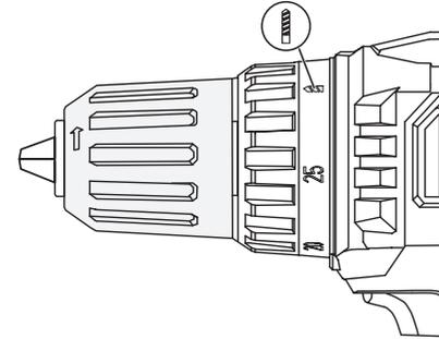
Во избежание травм, не заворачивайте шурупы в положении
