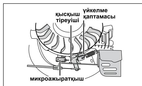
► 4 тежеуіштің рычагын басу арқылы микроажыратқыш сояуына қысқыш тіреуішпен тиіңіз;
