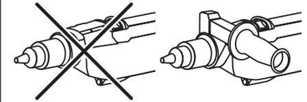
Работа без установленной дополнительной рукоятки ЗАПРЕЩАЕТСЯ.
