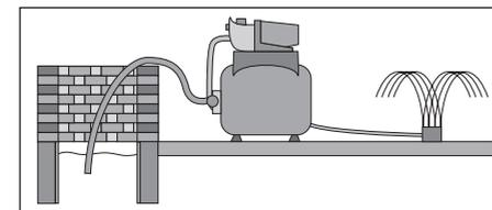
використовуйте пристрій для фільтрації води, що поступає в насос (сітка, фільтр попереднього очищення).
